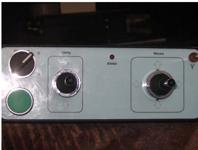
Telecomandă pentru acționarea de la distanță a unui pod rulant. Beneficiar: SC Ambient SA– Baia Mare
